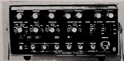
Die Parameter für TTL oder ECL sind beim PM 5718 mit Tasten schaltbar.
